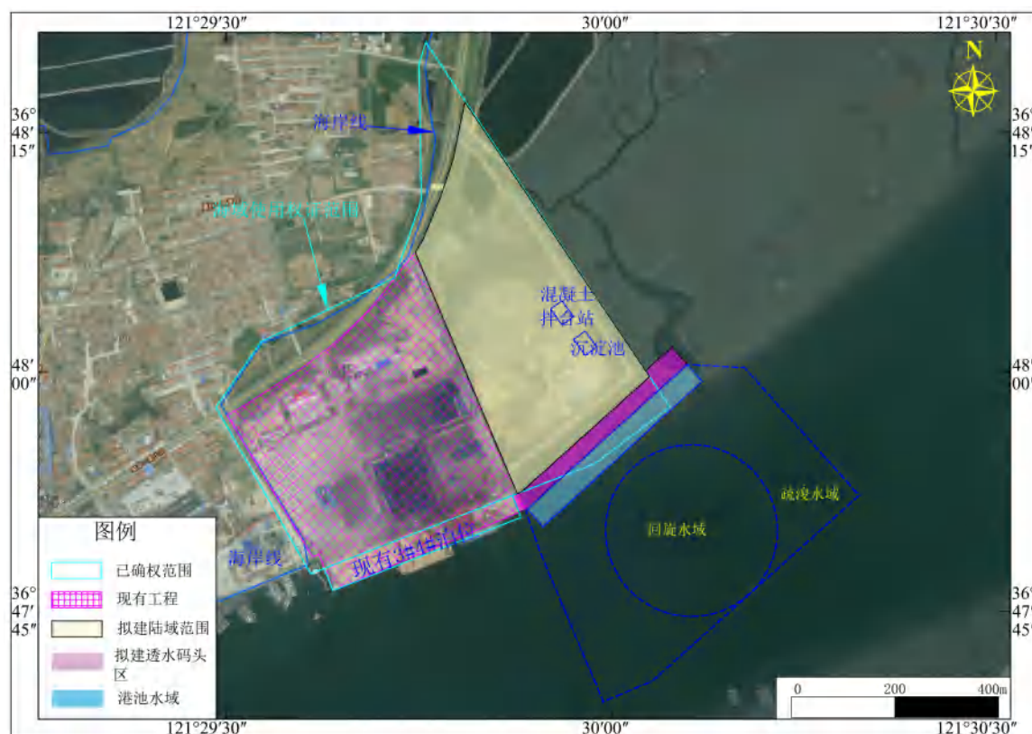
图 3.2-6b 施工期临时工程位置图
