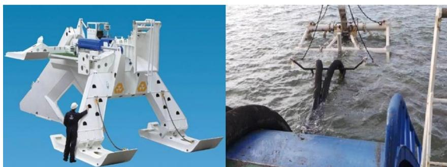
图 1.4-10 常规射水挖沟犁设备示意图
