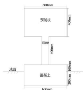
图 4-1 警示牌施工大样图
