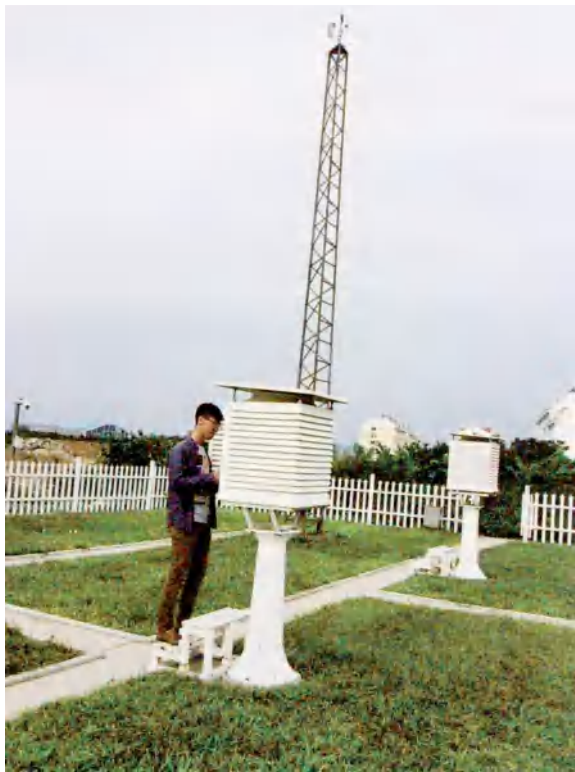
市气象局工作人员检查百叶箱仪器 (气象局提供)
