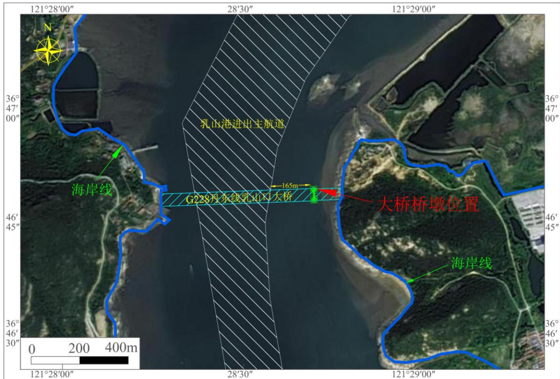
图 7.2-1 乳山口大桥桥墩与航道的位置关系
