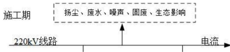
图 4-1 输电线路施工期主要污染工序图
