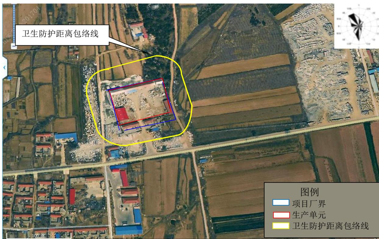
图4 卫生防护距离包络线图
