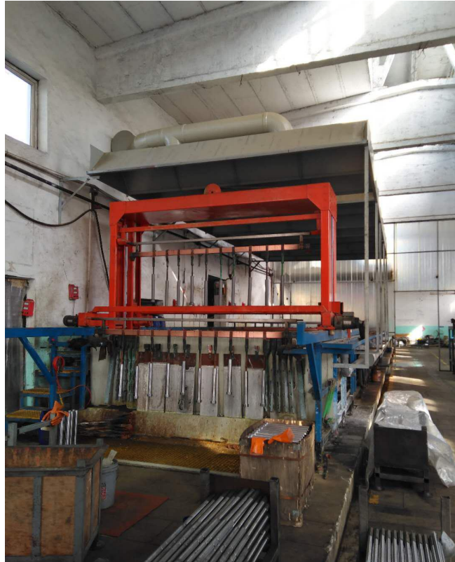
图 5.1-1 镀铬生产线顶部集气罩照片
